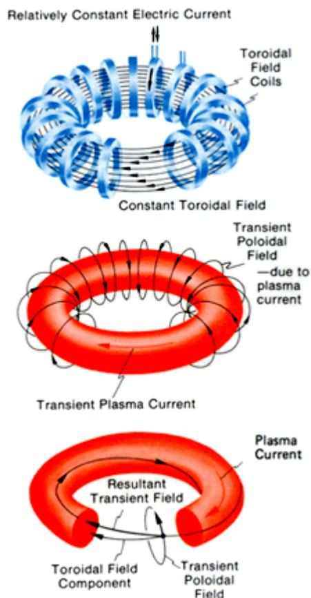
Per confinare il plasma in una macchina in configurazione tokamak i campi magnetici devono essere di tre tipi:
