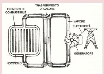
I reattori nucleari comprendono un nocciolo con elementi di combustibile nucleare radioattivo. Reazioni nucleari a catena in questo combustibile riscaldano una camicia d'acqua circostante che converte calore in vapore.
